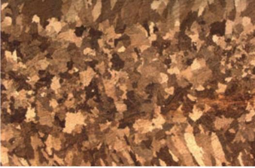
*Heterogener Gefügebau, grobes globulares Korn mit groben Stengelkristalliten durchsetzt – ungleichmäßige physikalische Eigenschaften*
