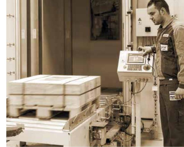
Über Schleusen werden Paletten mittels einem Regalbediengerät (RBG) voll automatisch ein- und ausgelagert. Das Hochregallager bietet eine effiziente Logistik, schnellen Zugriff auf alle Lagergüter und eine gute Bestandskontrolle.
